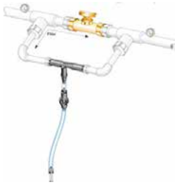
Injector parallel aan de hoofdstroom geplaatst
