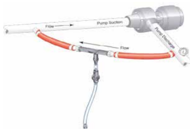
Injector geplaatst als "by-pass" over een pomp afsluiter van pers- naar zuigzijde
