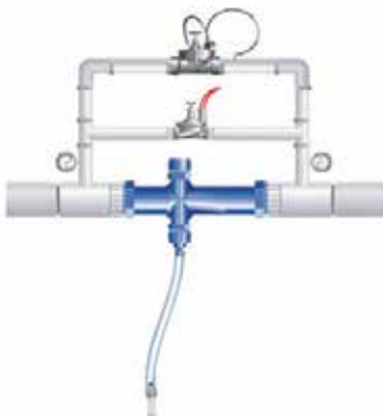
Injector in de hoofdstroom geplaatst. Injecteren start wanneer de kraan is gesloten. Bij een geopende kraan stopt het injecteren door afname in druk
